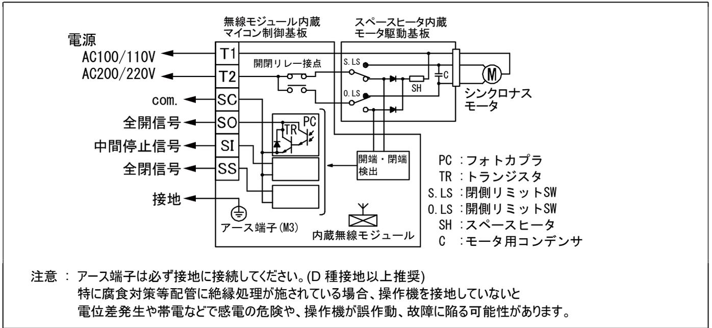
構造図・外形寸法図
