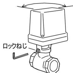
ロックねじを緩めると、電動操作機が回転可能になり直接操作機を回転させ手動操作が可能。
