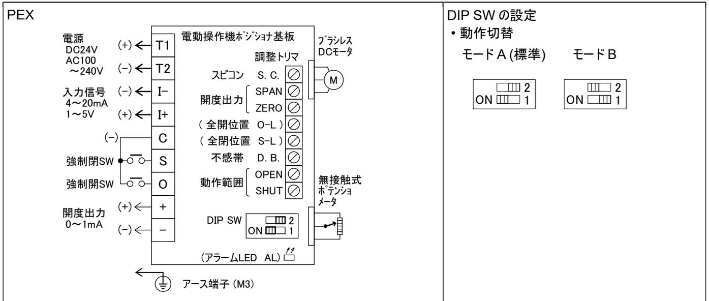
注意 ・ O-L トリマと S-L トリマは、強制開閉動作時に停止する位置で出荷時に調整済みです。変更できません。
