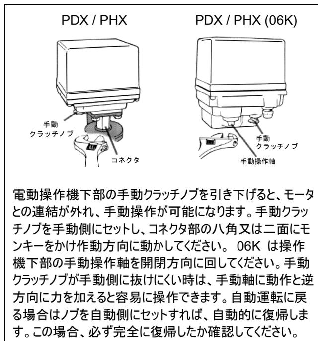
いずれも自動運転に移る前に必ずモンキーは外してください。
