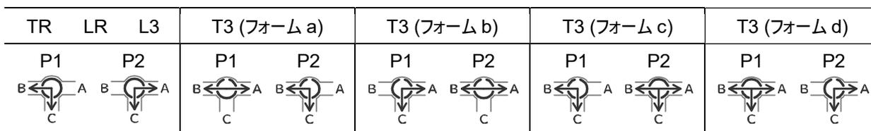
注) 閉止側ポートから高い圧力がかかると、流路側に漏れを生じます。(TR / LR)
