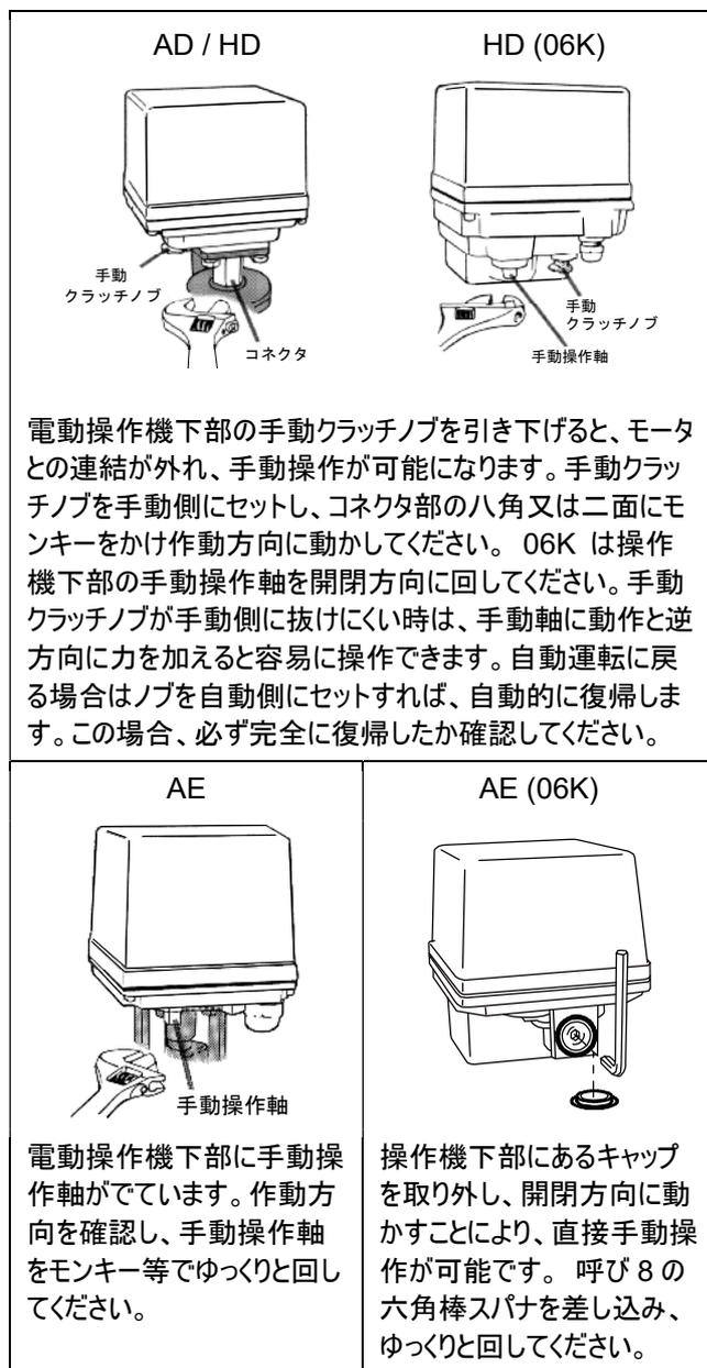
いずれも自動運転に移る前に必ずモンキーは外してください。
