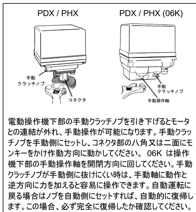
いずれも自動運転に移る前に必ずモンキーは外してください。
